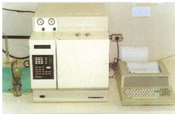
Figura 4. Cromatógrafo gasoso utilizado na análise das amostras.
