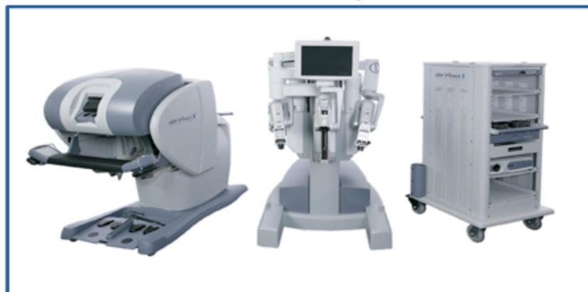
Figura N° 1: Componentes del Sistema Robótico Da Vinci®.
